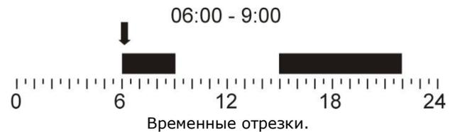
Выше приведен пример от 00:00 до 06:00 контроллер понижает заданную температуру на значение снижения. От 06:00 до 09:00 контроллер поддерживает заданную температуру котла. От 09:00 до 15:00 контроллер снизит заданную температуру на установленное значение. С 15:00 до 22:00 контроллер опять будет поддерживать заданную температуру.
