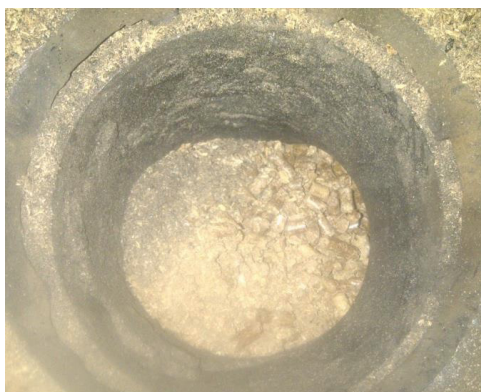
Hořák vyčištěný z uhlíkových ložisek - pohled na retorty shora
