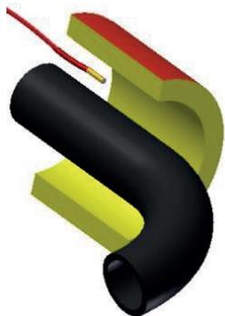
Diagramm der Positionierung des Temperatursensors.
